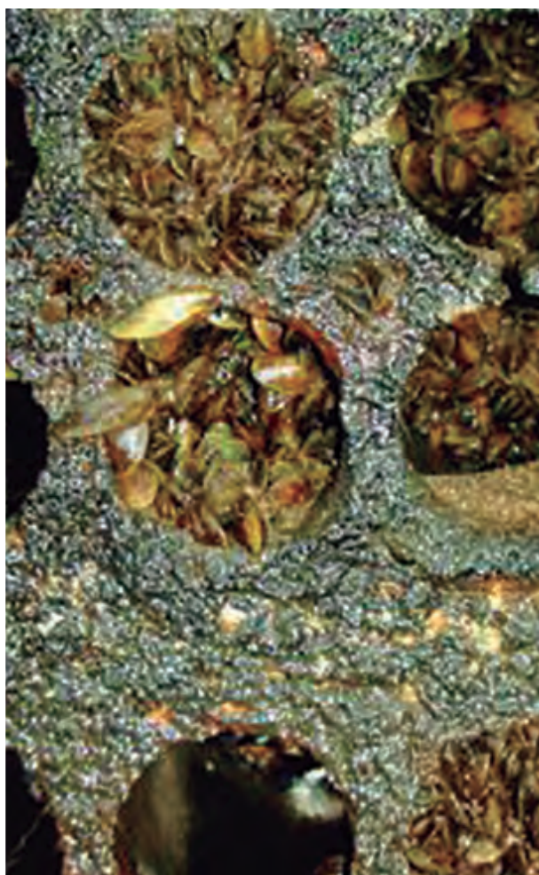
Incrustaciones en conductos de una planta potabilizadora.
